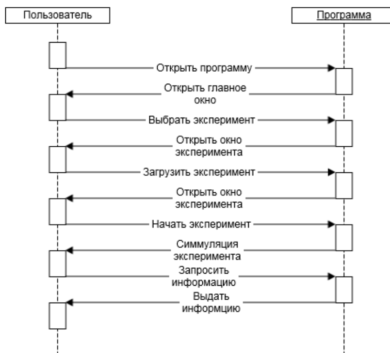
Рис. 4. SequenceTest – последовательность выполнения симуляции эксперимента при работе с виртуальной лабораторией (sequence diagram)
