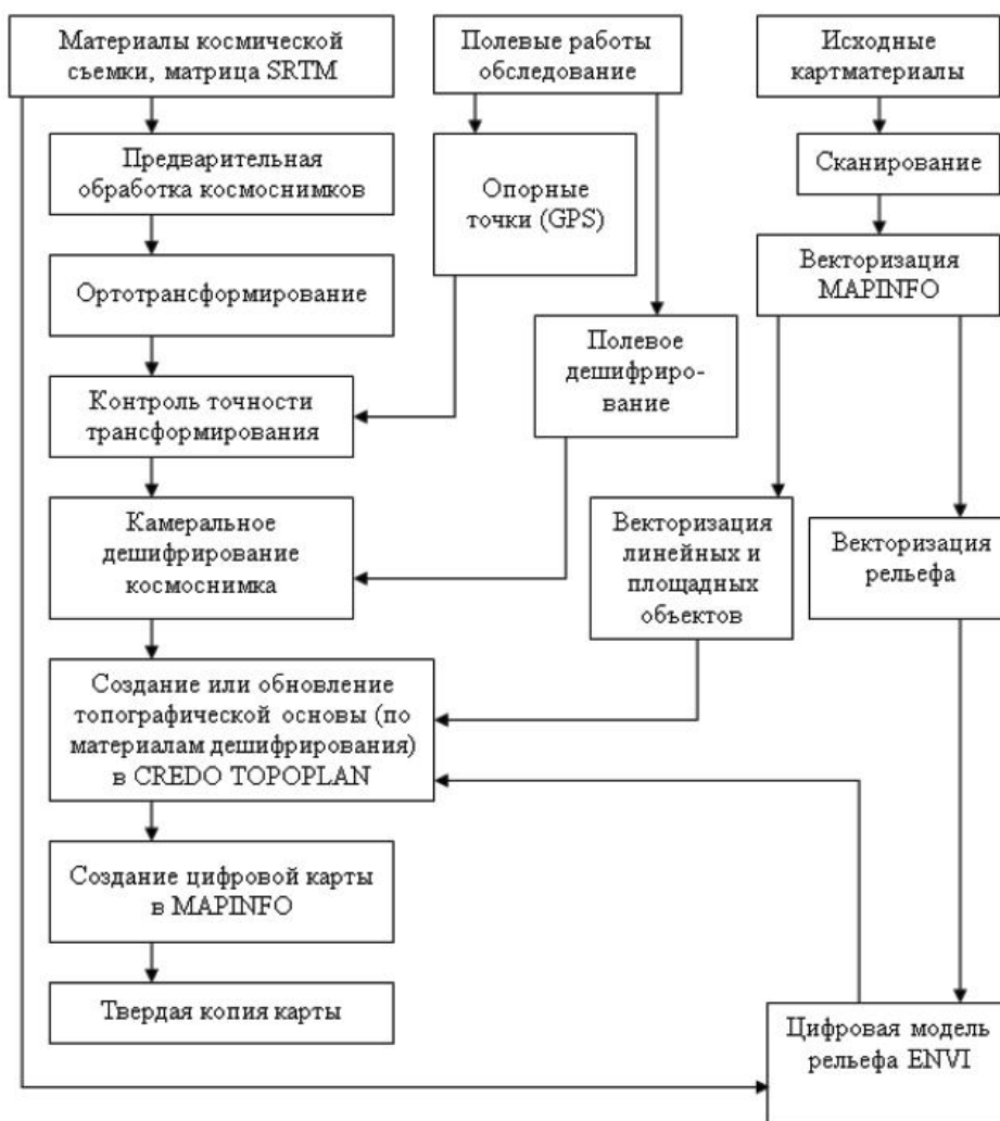
Рис. 1. Технологическая схема создания цифровых карт и планов по материалам космической съемки высокого разрешения
