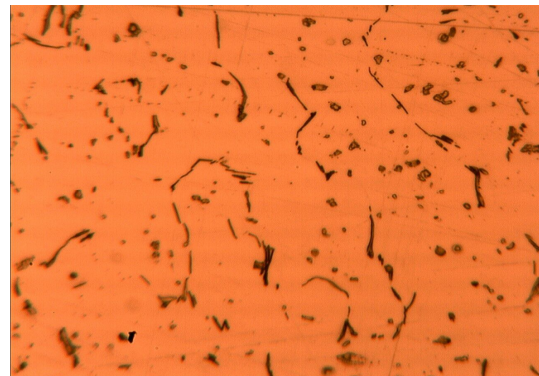
Сурет-3. Зауыттық технологиямен құйылған қорытпа микроқұрылымы: қатты ерітіндідегі ірі түйіндер (Al), артық фаза кристалдары және метал емес кірмелер.
