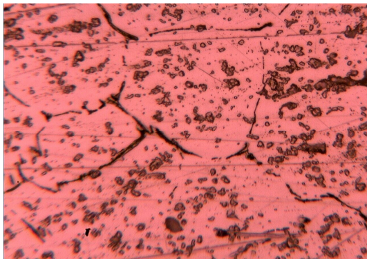
Сурет-3. Зауыттық технологиямен құйылған қорытпа микроқұрылымы: қатты ерітіндідегі ірі түйіндер (Al), артық фаза кристалдары және метал емес кірмелер.
